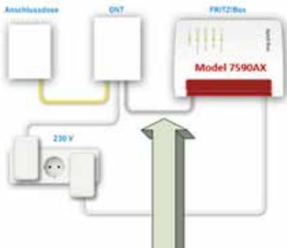
Verbinden Sie den LAN-Port des ONT (Glasfasermodem) mit der blauen Buchse „WAN“ der FRITZ!Box.
