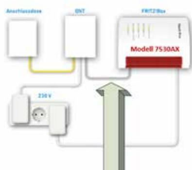
Verbinden Sie den LAN-Port des ONT (Glasfasermodem) mit der ersten gelben Buchse „LAN1“ der FRITZ!Box.
